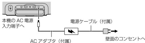
充電中は、本機のバッテリーインジケータがひとつずつ点灯していきます。5つのインジケータがすべて点灯したら充電完了です。
